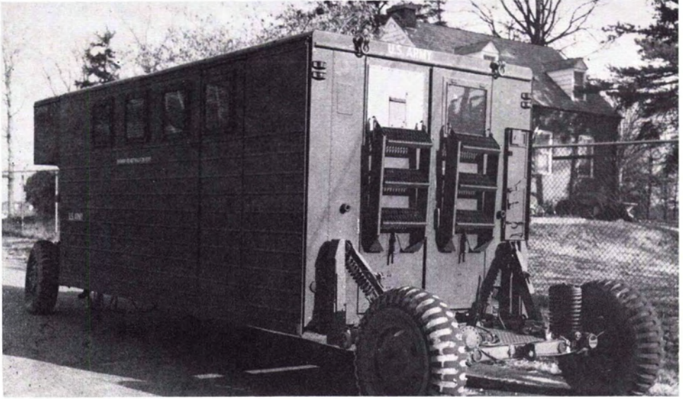
FIG. 1. The M-4 Expansible Van.
